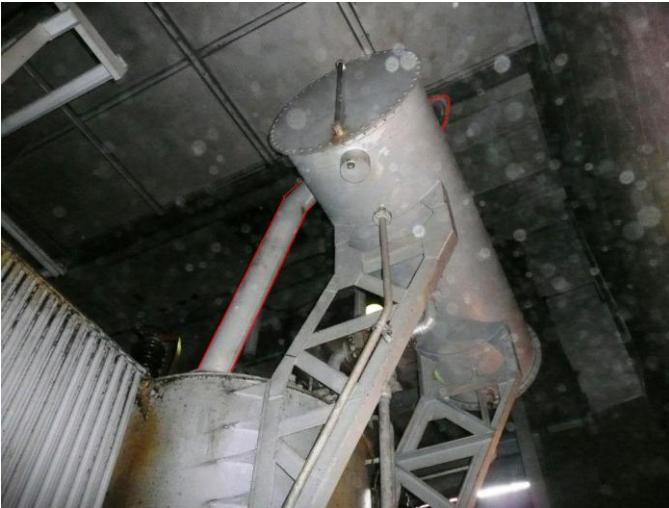
снимка 9: експлозионен сепаратор, виж червените линии
