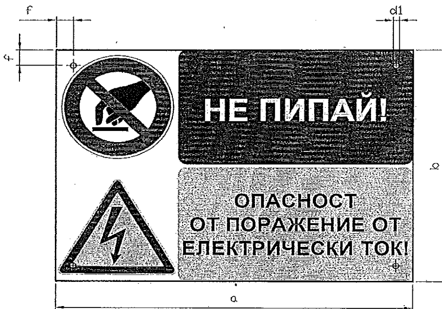
Фиг. 2 Табела „Не пипай! Опасност от поражение от електрически ток!“
