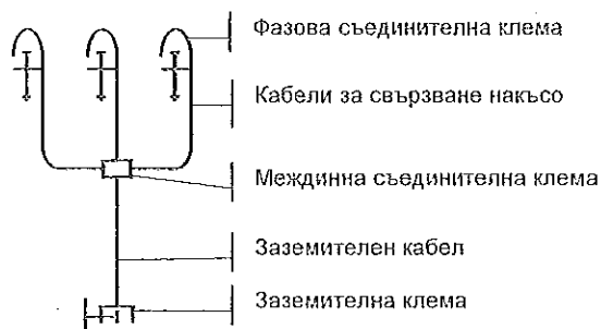
Фиг. 1 – Триполюсен преносим заземител
